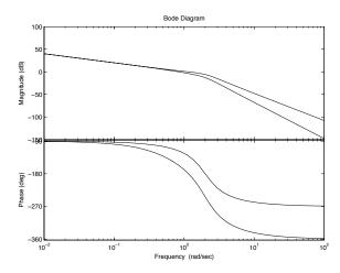
Skalan på frekvensaxeln kan väljas genom att som sista argument i funktionsanropet ange största och minsta frekvensvärdet mellan krullparenteser .
