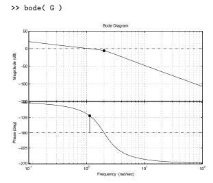
För att bestämma skärfrekvenser samt fas- och amplitudmarginal kan man även använda funktionen margin, vilken förutom att rita upp amplitud- och faskurvorna även skriver ut dessa värden. Gm och Pm betecknar amplitud- respektive fasmarginal.
