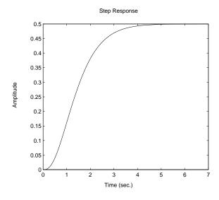
På detta sätt ser vi endast den utsignal som definieras av vektorn C. Vill vi studera samtliga tillstånd kan detta göras genom att låta C vara en enhetsmatris med dimension lika med systemets ordningstal.
