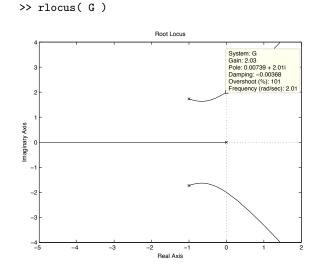
För att t ex kontrollera för vilken förstärkning polerna har viss dämpning kan man med höger musknapp lägga in ett nät vilket markerar polplaceringar med samma avstånd till origo respektive samma dämpning.
