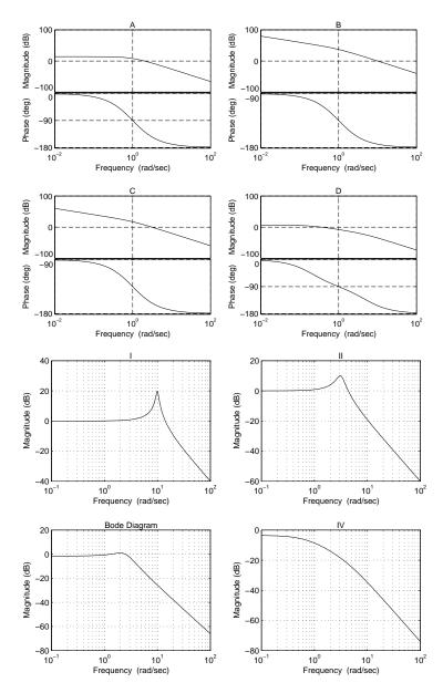
Figure 5.17a. Upper:  $G_O(i\omega)$ . Lower:  $\mid G_C(i\omega) \mid$ .
