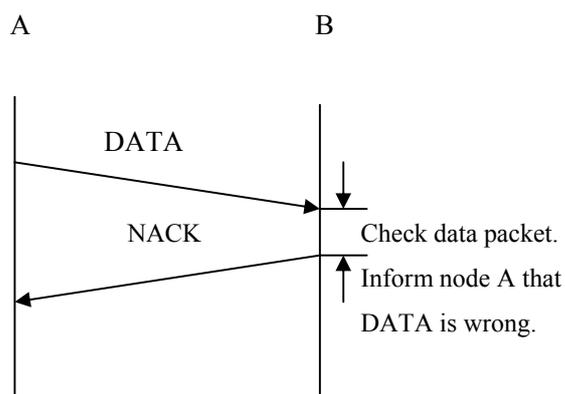
Figure 2-8 (d) Error control in data link layer - DATA is wrong
