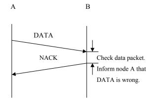
Figure 2-8 (d) Error control in data link layer - DATA is wrong
