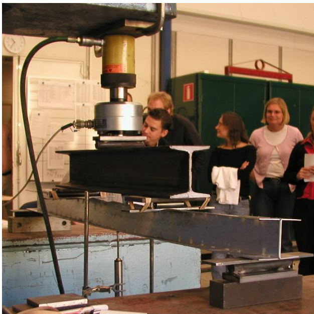
Figur 1.5 Lastuppställning från labbförsök av balk A.
