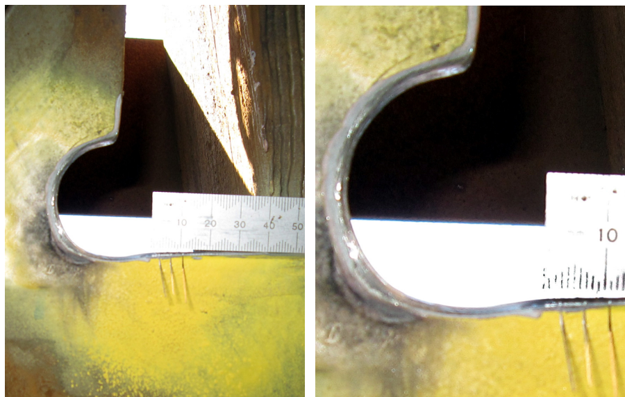
Figur 9: a) anslutning mellan tvärplåt och överfläns långbalk, efter bearbetad geometri, b) detalj vid svets och placering av givare, radie ca. 20 mm.
