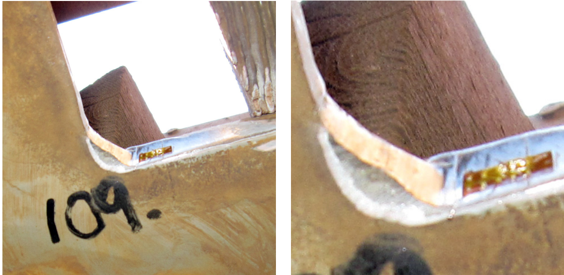
Figur 8: a) anslutning mellan tvärplåt och överfläns långbalk, före bearbetad geometri, b) detalj vid svets och placering av givare.
