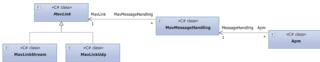
Abbildung 3.6: UML Diagramm für den Nachrichtenzugriff auf einem Übertragungskanal.
